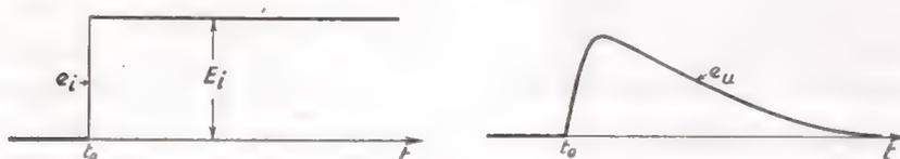
Fig. 14 — Generica risposta di un circuito lineare ad un segnale a gradino.
