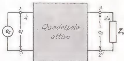
Fig. 7 — L'amplificatore è un quadripolo attivo interposto fra il generatore del segnale e l'utilizzatore.
